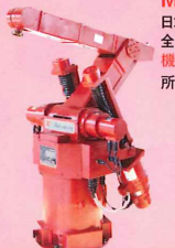
MOTOMAN-L10 日本で初めて製品化された全電気式産業用ロボット 機械遺産/未来技術遺産 所蔵：安川電機
