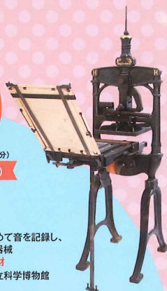
平野富二の活版印刷機 明治初期の印刷文化に貢献した国産活版印刷機 機械遺産 所蔵：ミスノプリンティングミュージアム
