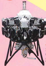
二式一五〇馬力発動機 かつての日本の航空機技術を示す 中島飛行機製のエンジン 所蔵：国立科学博物館
