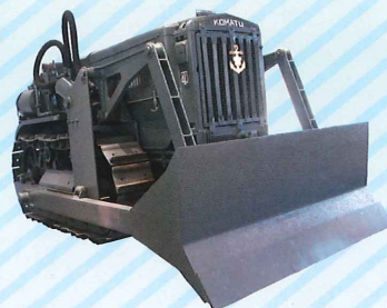
コマツブルドーザーG40(小松1型均土機) 日本最初のブルドーザー 機械遺産 所蔵：コマツ
