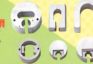
K.S鋼、新K.S鋼 世界も驚いた強力磁石 日本の磁性材料研究の先駆け 所蔵：東北大学
