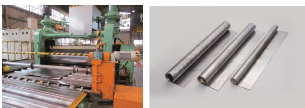
鉛板圧延機と鉛板-耐食性、遮音性、放射線遮蔽性に優れています-
