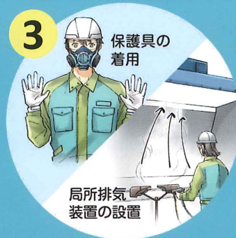
3 保護具の着用 局所排気装置の設置
