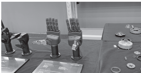
ロボットハンドと細かなパーツ。 左は人型ロボットの手部、右は各種メカニカル部品
